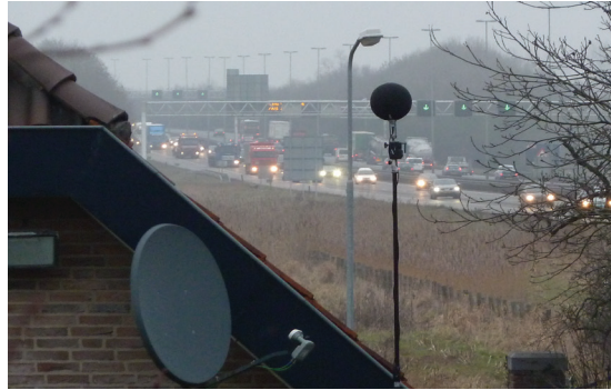
Geluidmonitoring A50: vaststellen nulsituatie
