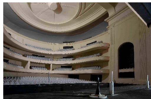
Abbildung 6: Bild im Maßstabsmodell mit der erhöhten Decke und Nachhallgalerie. Im Vordergrund eine rundum strahlende Hochfrequenzquelle und ein Mikrofon mit Vorverstärker.
