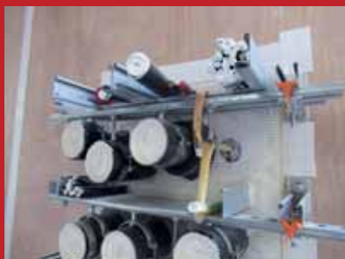
Een rookdoorlatendheidsproef van gemixte doorvoer conform EN 1634-3 (na proef bij middelwarme rook S200).
