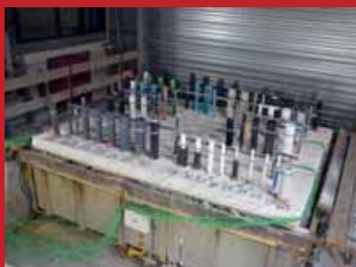
Een brandwerendheidsproef van een vloer met doorvoeringen conform EN 1366-3 (tijdens instrumentatie).
