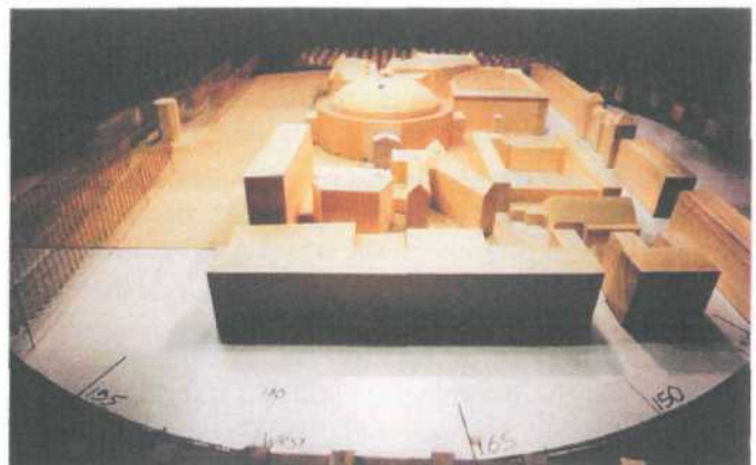
Bild 11. Modell für Windkanaluntersuchung Fig. 11. Scale model in windtunnel
