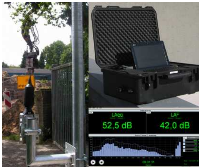
Figuur C - Geluidmonitoring in de woonomgeving met het Peutz Monitoring System
