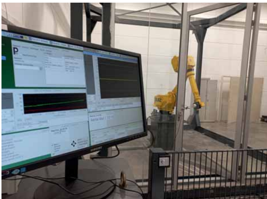
Met de 'PiMs' meetsoftware is de mogelijkheid gecreëerd om op afstand mee te kijken naar de open- en sluitijden en de omstandigheden in het lab (de pui is van Vitriwand).
