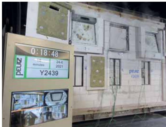
Typeringstest EN 1634-2 voor MHB, na 18 minuten (foto: Peutz).
