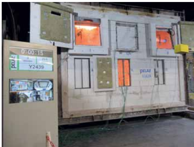
Typeringstest EN 1634-2 voor MHB, aanvang test (foto: Peutz).
