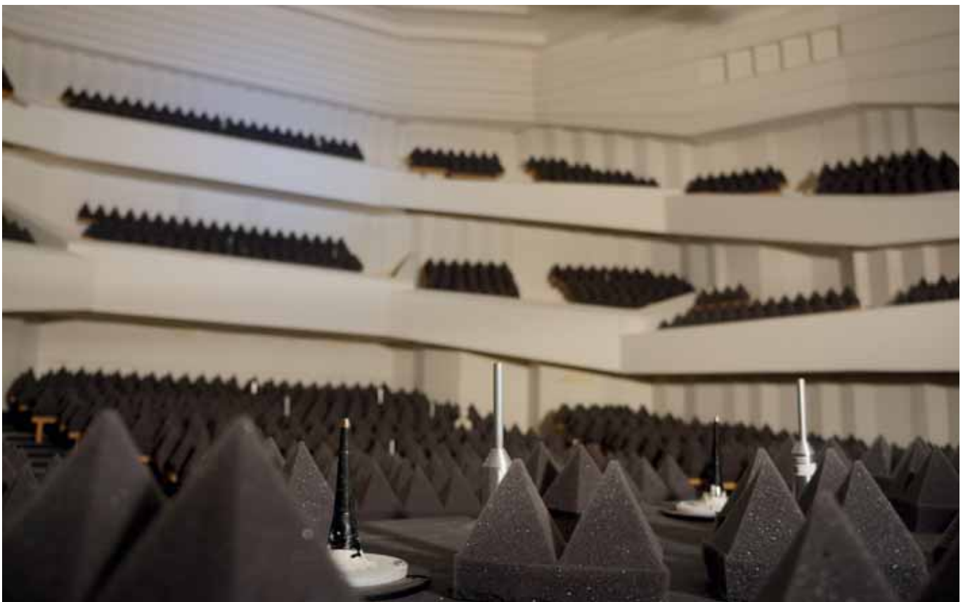
FIGUUR 3: LINKS: HOOGFREQUENTE GELUIDBRON: IN HET PODIUM INGEBOUWDE TWEETERS MET HIEROP EEN KOOLSTOF CONUS; 1/4" CONDENSATOR MICROFOONS MET IN DE VOET (VERBREIDING) DE VOORVERSTERKER; PUBLIEK EN MUSICI GEMODELLEERD MET GELUIDABSORBERENDE SCHUIMPYRAMIDES. SCHAALMODEL KULTURPALAST DRESDEN 1:10.
