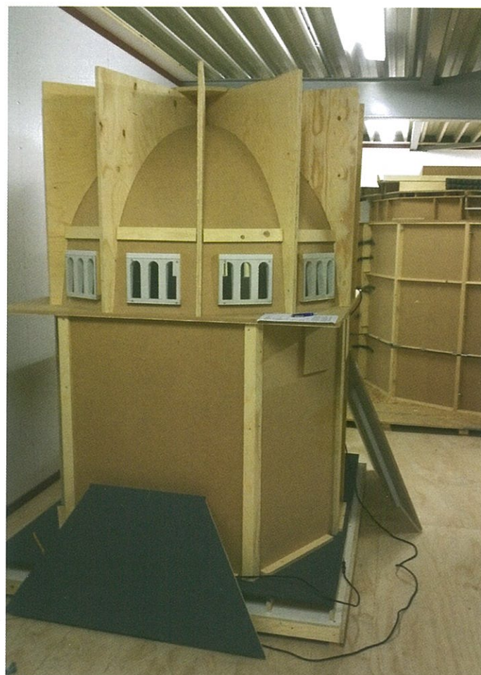
Met hulp van een schaalmodel is onderzocht met welke maatregelen een gelijkmatige energieverdeling gerealiseerd zou kunnen worden.
