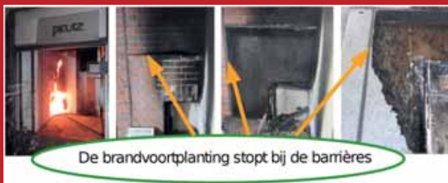
Verlengde SBI-test inclusief kunststof kozijn in analogie met EN 13823.
