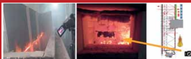
Brandtest volgens EN 1363-1 met de standaard brandkromme: simulatie brandtrajecten 1,2 en 3 om de vloerrand heen.
