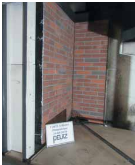
SBI-test volgens EN 13823: Prefab renovatieschil.
