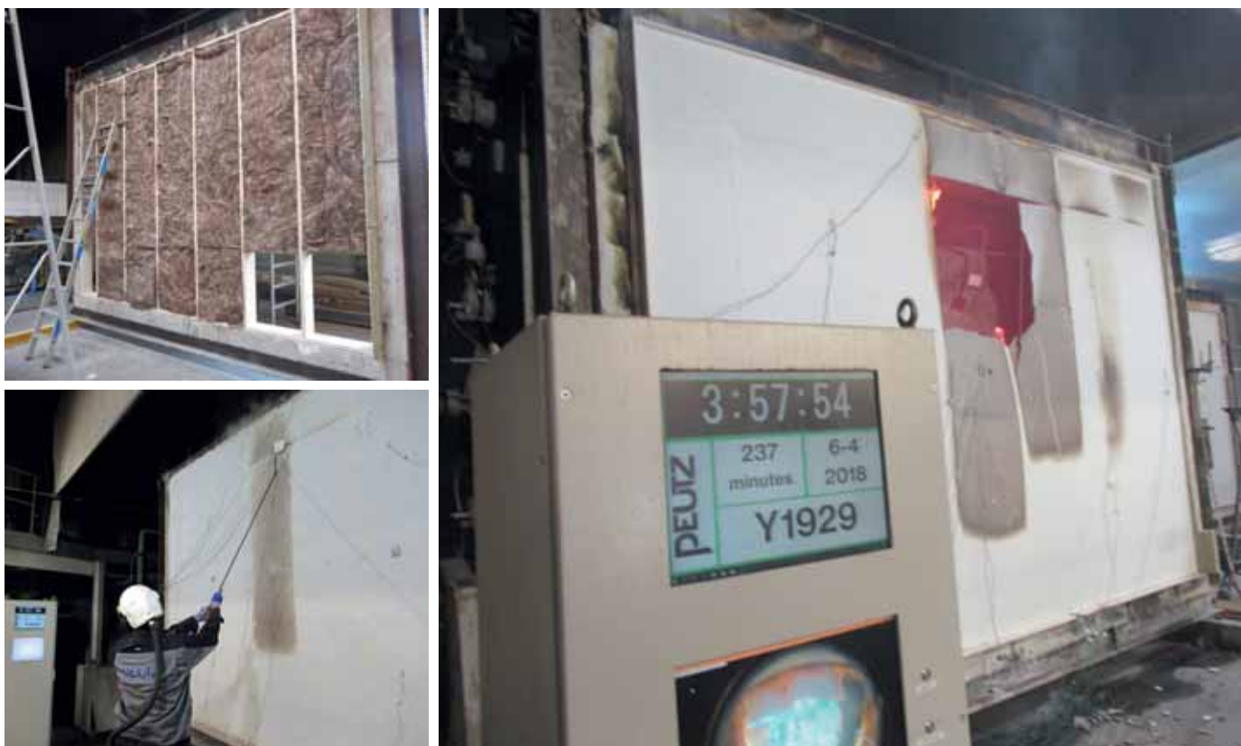
Brandtest volgens EN 1364-1: Niet-dragende houtskeletbouw buitengevel.
