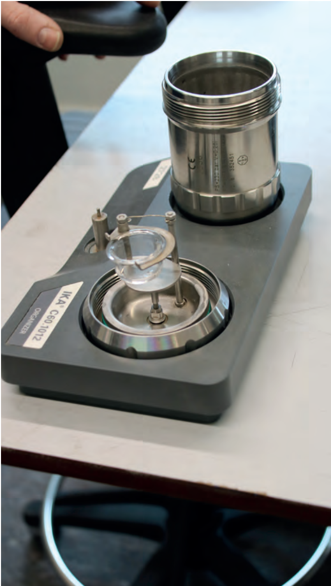
Dit apparaat heet 'bom-calorimeter': een beetje materiaal wordt ontstoken in een omgeving van 100 procent zuurstof. Dat levert volledige verbranding op.
