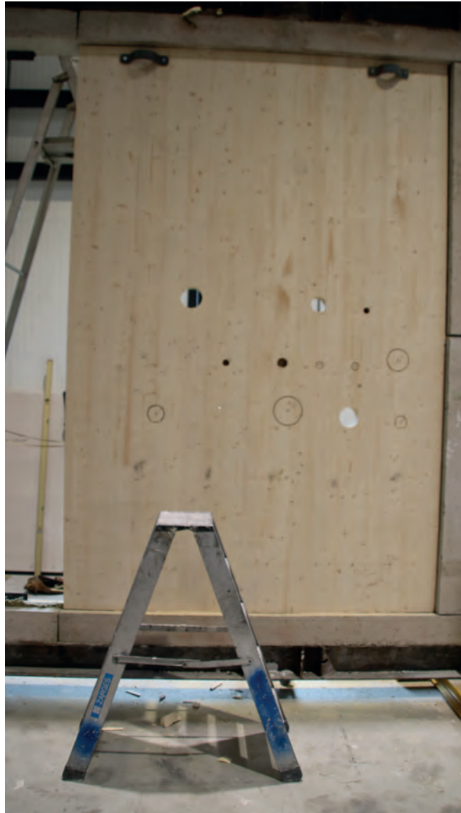
Met en aan CLT wordt veel onderzoek gedaan. Hier wordt een wand klaarge- maakt voor het testen van brandvertragende doorvoeren.
