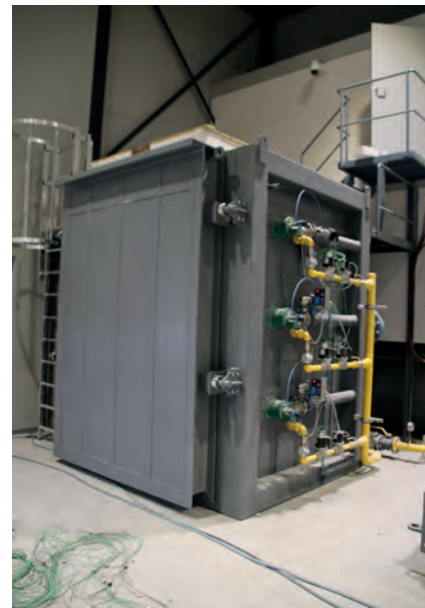
Deze nieuwe oven test wanden of, zoals hier, plafonds, maar ook beide bouwdeelen tegelijk kan, plus hun aansluiting.
