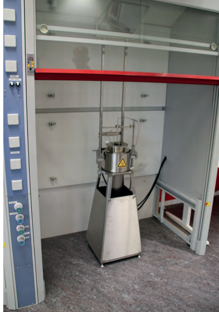
De nieuwe oven waarmee de 'onbrandbaarheidstest' volgens alle normen wordt uitgevoerd.
