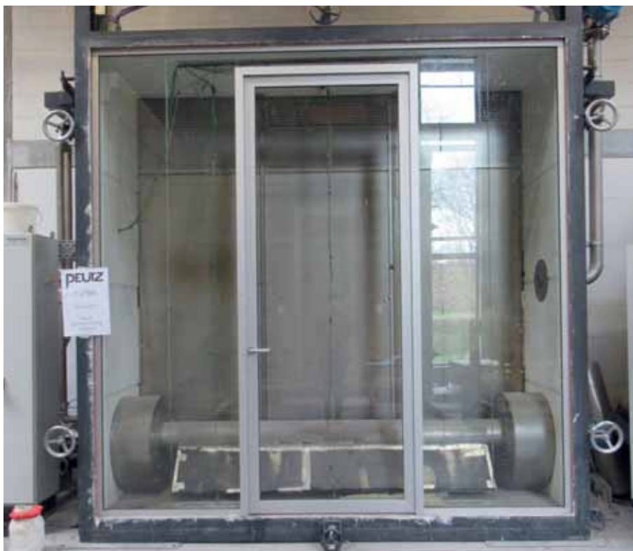
Rookdoorlatendheidsbeproeving in een geassocieerde ondersteuningsconstructie van glas (foto: Vitriwand).
