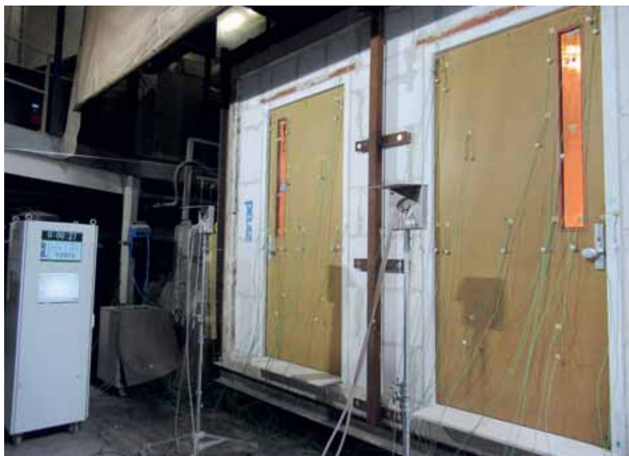
Brandwerendheidsbeproeving in een stijve ondersteuningsconstructie (foto: Berkvens).
