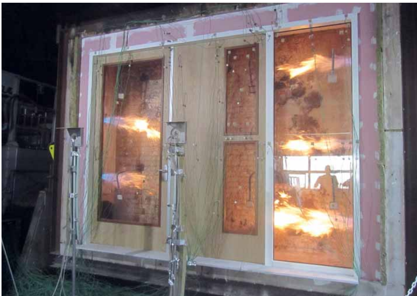
Brandwerendheidsbeproeving in een flexibele ondersteuningsconstructie (foto: Van Vuuren en Staalkozijn).
