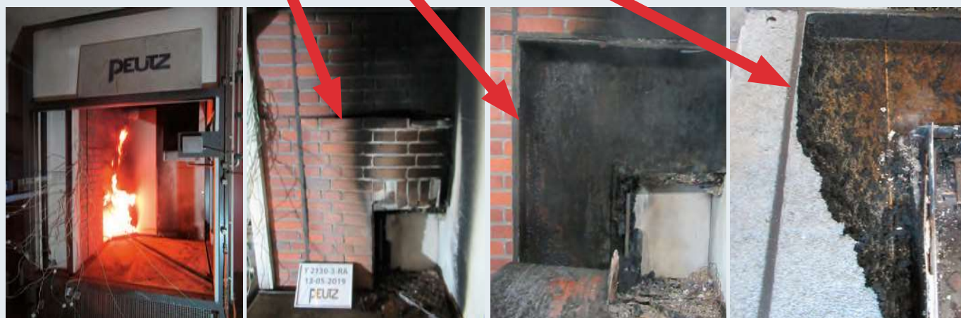
Verlengde SBI-test inclusief kunststof kozijn in analogie met EN 13823.
