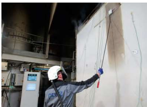
Brandtest volgens EN 1364-1: niet-dragende houtskeletbouw buitengevel.
