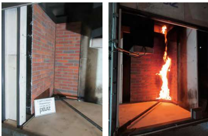
SBI-test volgens EN 13823: prefab renovatieschil, hier een complete mock-up van een renovatiegevel.
