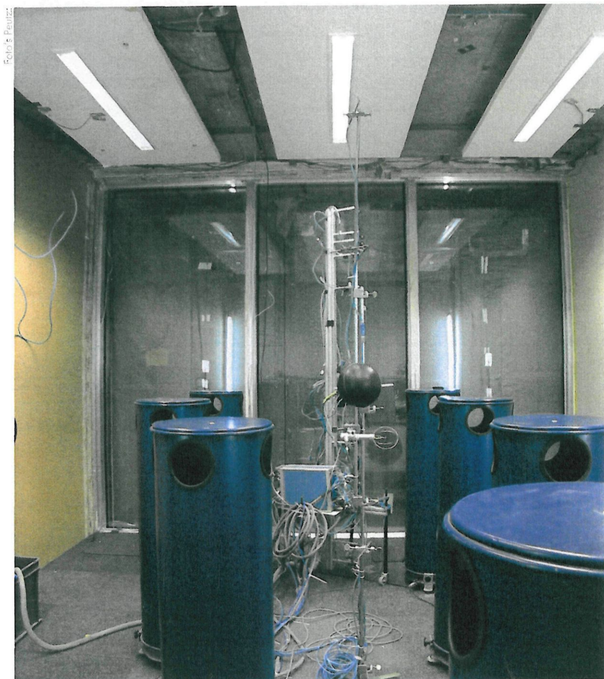
■ Klimaatkameronderzoek naar plafonds met minerale wolplaten.
