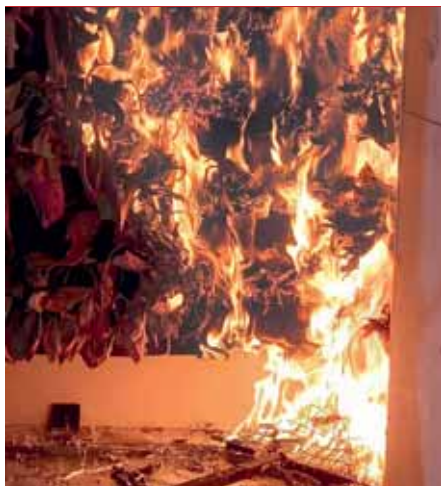
SBI-test van een groene gevelsysteem met gedroogde planten (Diks, 2022).
