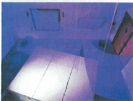
AKUSTIK-LABOR VON PEUTZ: In einem Hallraum werden Baumaterialien und Konstruktionen wie Theaterstühle auf ihre Schallabsorption hin untersucht.
