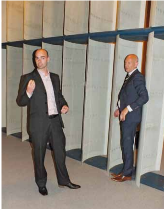
De hoekschoepen geleiden de wind in goede banen en dempen het ventilatorgeluid zodat een schone en stille luchtstroming in de windtunnel ontstaat.
