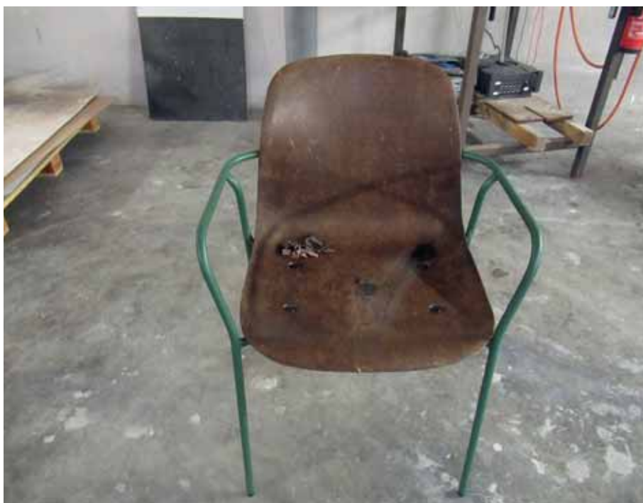
Foto 4. Bij een stoel met metalen poten heeft een test tegen de stoelpoot of onder het zitvlak weinig zin.
