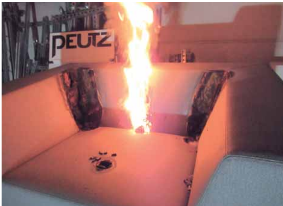
Foto 1. Escalerende brand aan een fauteuil tijdens een test.
