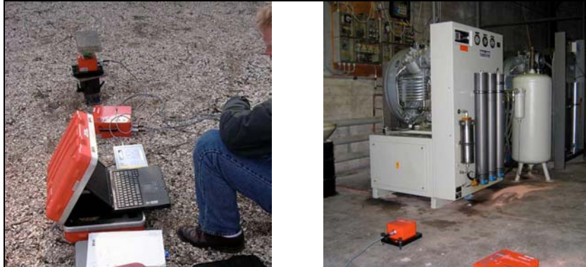
Figuur 5 Meting van de trillingniveaus bij het intrillen van damwanden (links) en bij de opstelling van een compressor (rechts).
