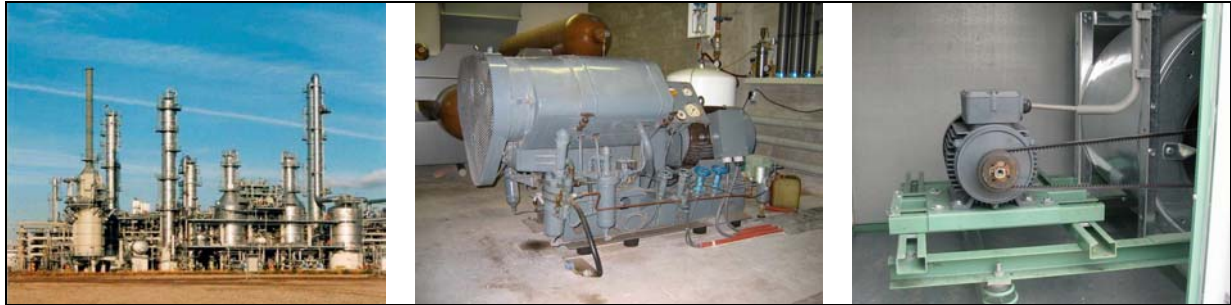
Figuur 3 Voorbeelden van trillingbronnen zoals zware industrie in de omgeving (links), een procesgebonden heliumcompressor (midden) of de luchtbehandelingsinstallatie (rechts).
