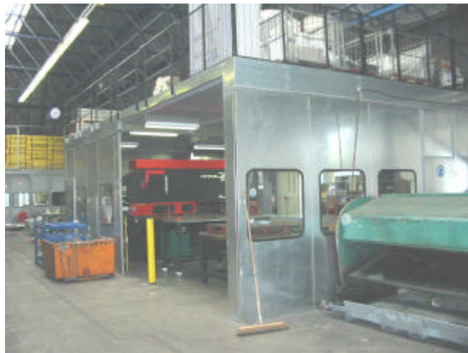
Figuur 1 Voorbeeld van omkasting van stansmachine
