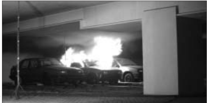
Grote schaal brandproef in een parkeergarage.
