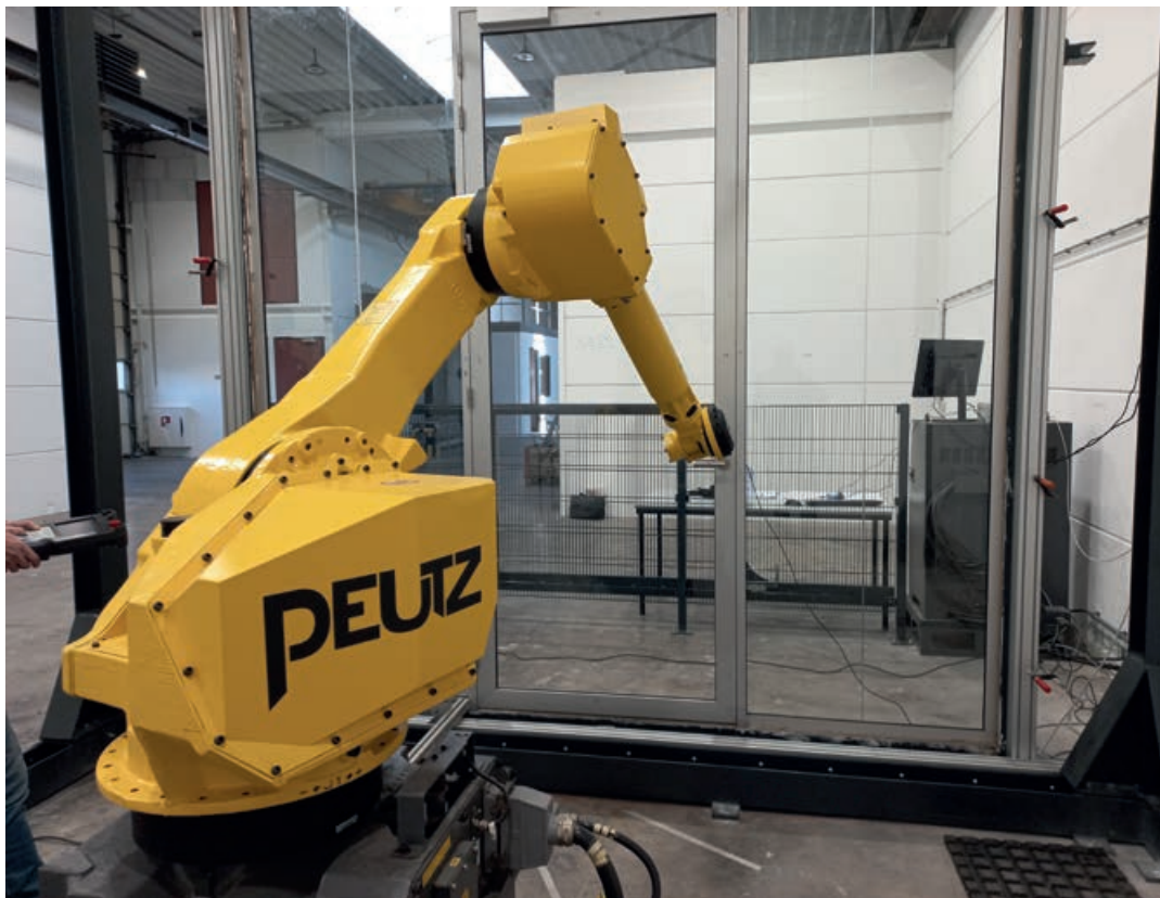
▲ De opstelling conform EN 1191. Een C5-test duurt circa een maand, hier met een rookwerende met aluminium omlijste deur in een glaswand zonder stijlen.
