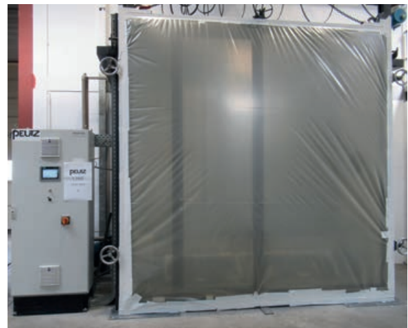
Meting van de lekkage van het kastverlies; het proefstuk is afgeplakt.
