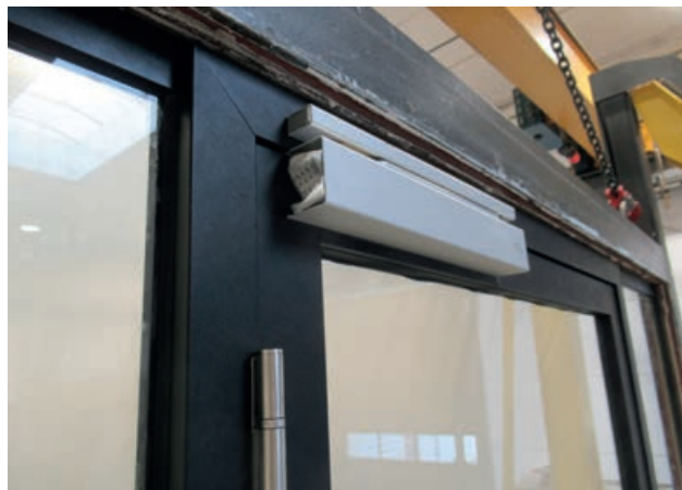
Deurdranger na afloop van beproeving bij 200 °C ( S_{200} ).
