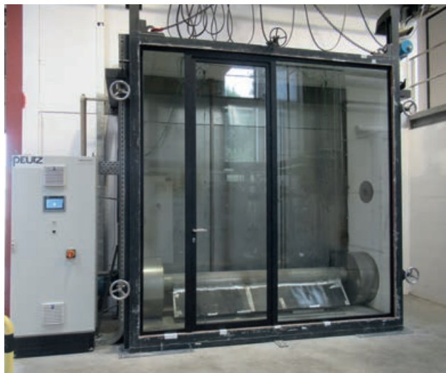
Testopstelling met systeemwand van Intermontage voor de bepaling van de rookdoorlatendheid volgens EN 1634-3.
